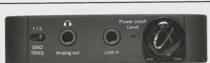
機身頂端最顯眼的位置，自然是一顆印有ADL的logo「Alpha」的音量旋鈕。頂板中央是一顆Line in插頭，這是唯一可用Android作業聽歌的插頭。左側一顆耳機插頭，旁邊有一顆GND TRRS打掣，1是吻合Sony格式，2是吻合蘋果器材格式。
